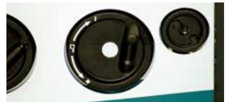
Verstellung Parallelanschlag mit Handrad und Handrad für Feineinstellung
