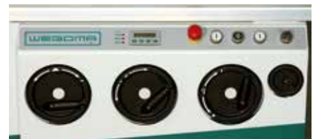
Bedienfront: Höheneinstellung, Winkeleinstellung, Verstellung Parallelanschlag
