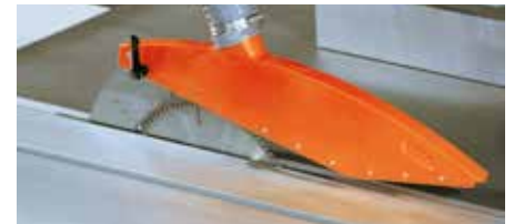
Sägehaube am Spaltkeil befestigt
