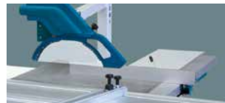
Parallelanschlag elektrisch gesteuert
