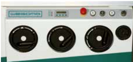
Bedienfront: Höheneinstellung, Winkeleinstellung, Verstellung Parallelanschlag
