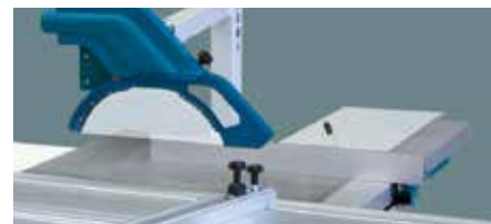
Parallelanschlag elektrisch gesteuert
